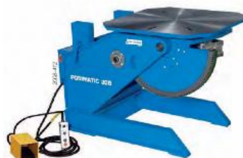
POSIMATIC 30B : 3000Kg à 140mm du plateau
